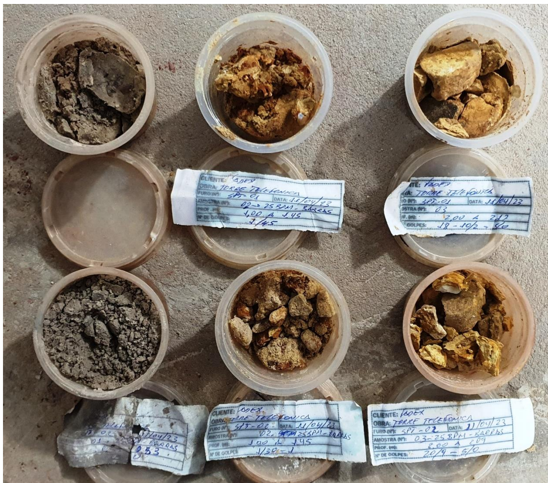
AMOSTRAS REPRESENTATIVAS DOS FUROS: SPT 01 E SPT 02 (VISUALIZAÇÃO: DE CIMA PARA BAIXO /ESQUERDA PARA DIREITA)
